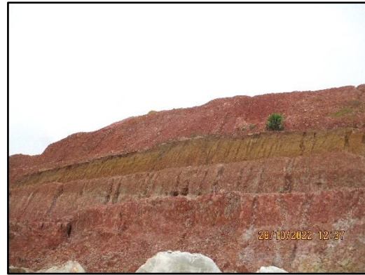
ภาพที่ 2.10 เปิดหน้าเหมืองแบบขั้นบันได
