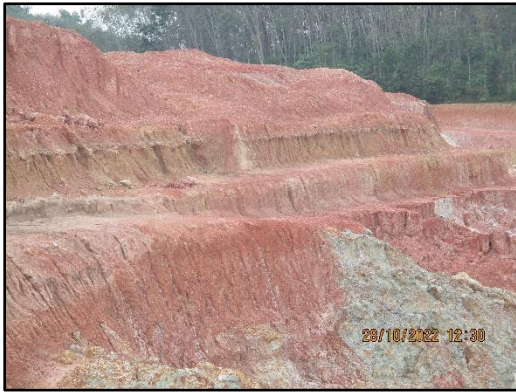
ภาพที่ 2.10 เปิดหน้าเหมืองแบบขั้นบันได
